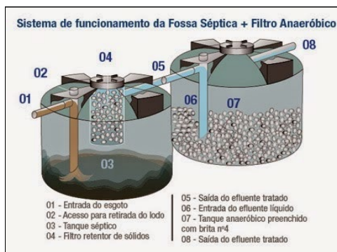
Sistema de funcionamento da FOSSA SÉPTICA
